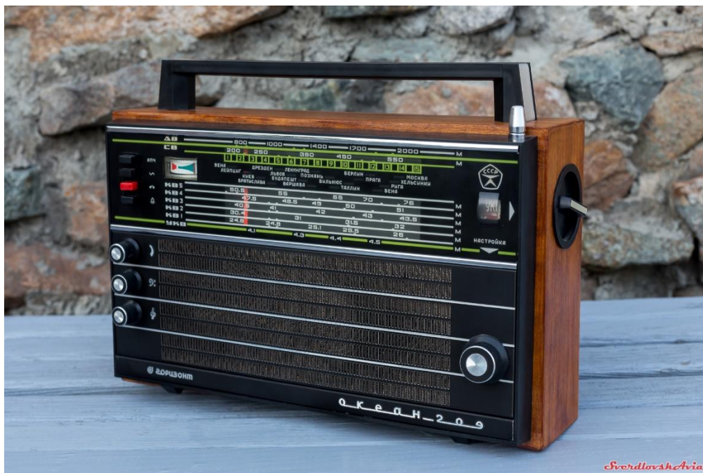
2.1-сурет – Екінші санаттағы ескі тасымалды транзисторлық радиоқабылдағыш
