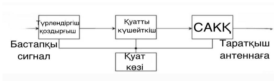
2.4-сурет – Радиотаратқыштың құрылымдық схемасы
