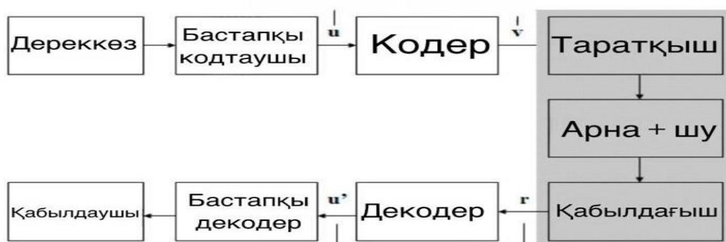
1-сурет – Сымсыз байланыс моделінің сұлбасы
